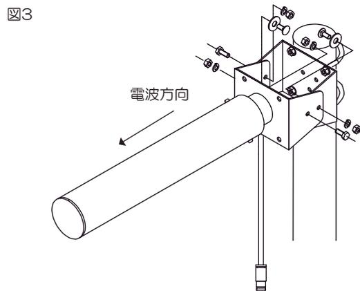
同軸ケーブルを接続します。コネクタをしっかりと接続してください。接続後、付属の自己融着テープ等で防水します。
