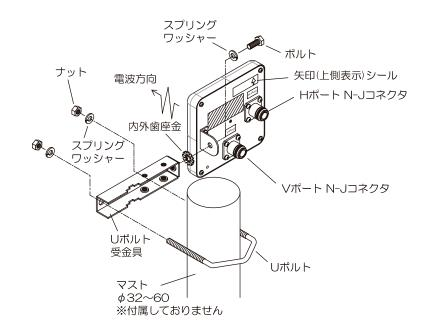
各接栓(Vポート・Hポート)に同軸ケーブルを接続します。
