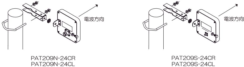
同軸ケーブルを接続します。コネクターをしっかりと接続してください。接続後、付属の自己融着テープ等で防水します。
