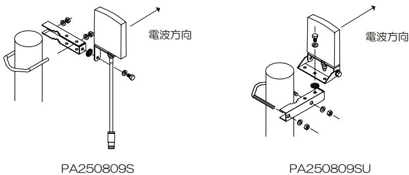
図2のように同軸ケーブルを接続します。コネクターをしっかりと接続してください。接続後、付属の自己融着テープ等で防水します。
