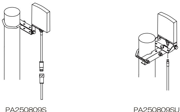
図3のように同軸ケーブルをマストにテープ等で止めてください。図のようなループを作る等、コネクター部に同軸ケーブルの荷重が加わらないような工夫をしてください。又、金具の向きを工夫する事により、色々な場所に取付られます。
