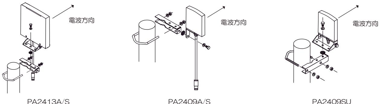
図2のように同軸ケーブルを接続します。コネクターをしっかりと接続してください。接続後、付属の自己融着テープ等で防水します。
