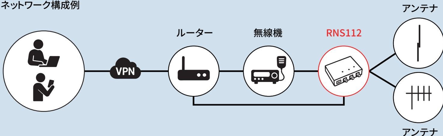
外出先でのちょっとした時間のリモート運用でもアンテナを切替可能
