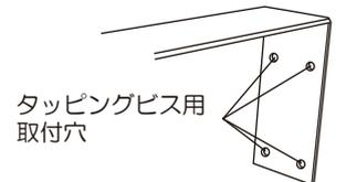
付属のタッピングビスで4箇所固定し、壁等に取り付ける
